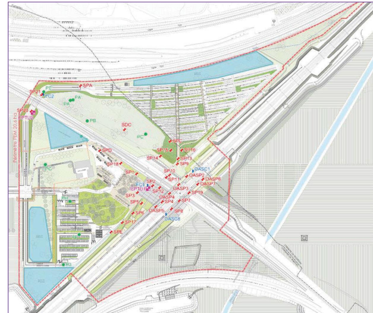
Figure 48 : Plan d'implantation des sondages géotechniques (Source : AREP Ville, Gares & Connexions, 2016)
