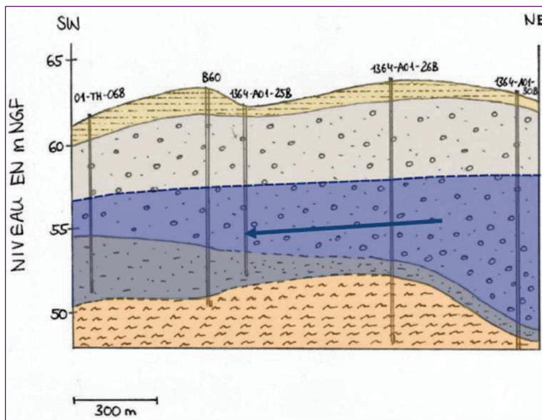
Figure 55 : Coupe géologique schématique avec piézométrie et zone saturée (coupe A) (source : Etude hydrogéologique de la gare nouvelle de Nîmes Manduel Redessan et du Projet Urbain Multimodal de Nîmes Métropole – Antéa Group – Juin 2015)
