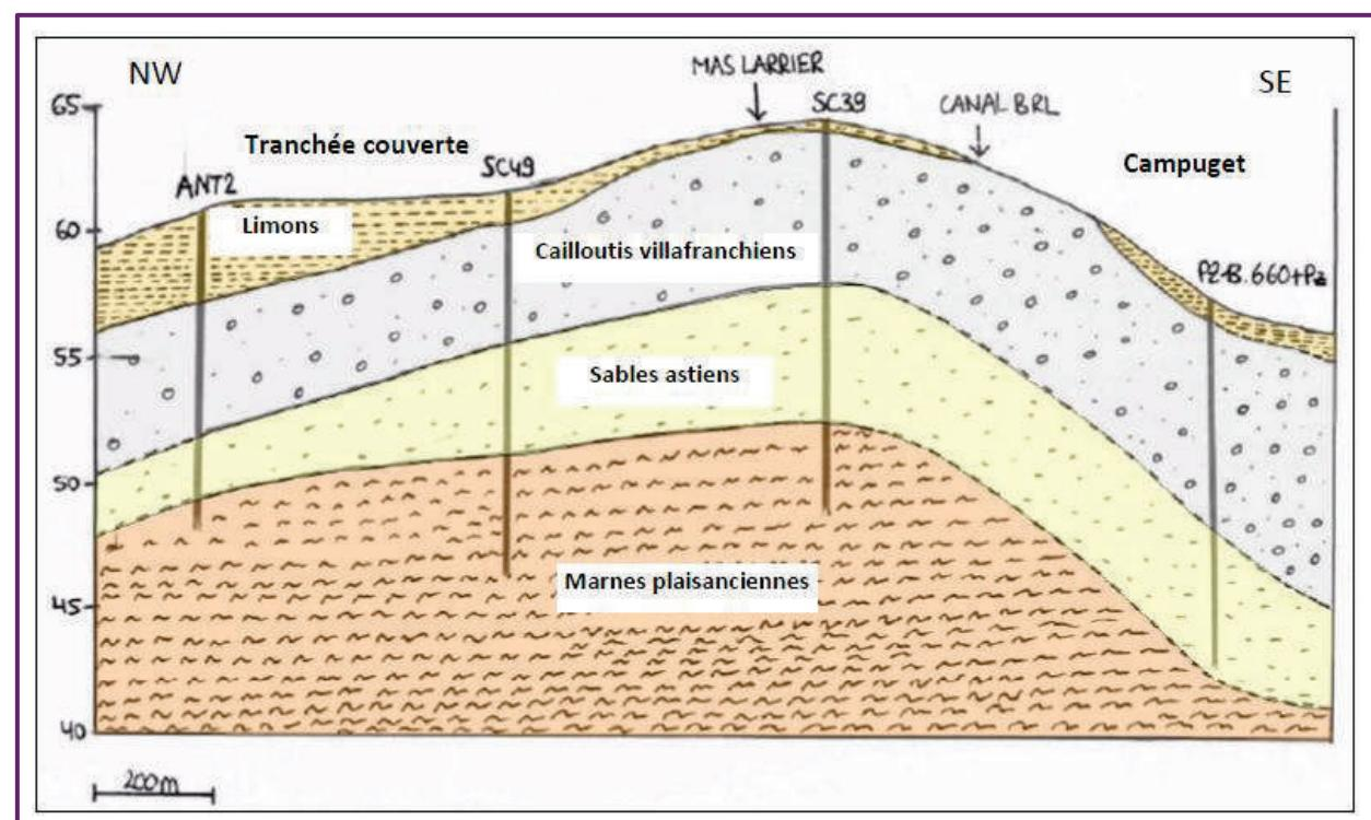
Figure 45 : Coupe géologique schématique (coupe A) au droit de la zone de projet (source : Suivi piézométrique au droit du projet de gare Nouvelle de Nîmes, Manduel et Redessan – Antéa Group – Mars 2016)
