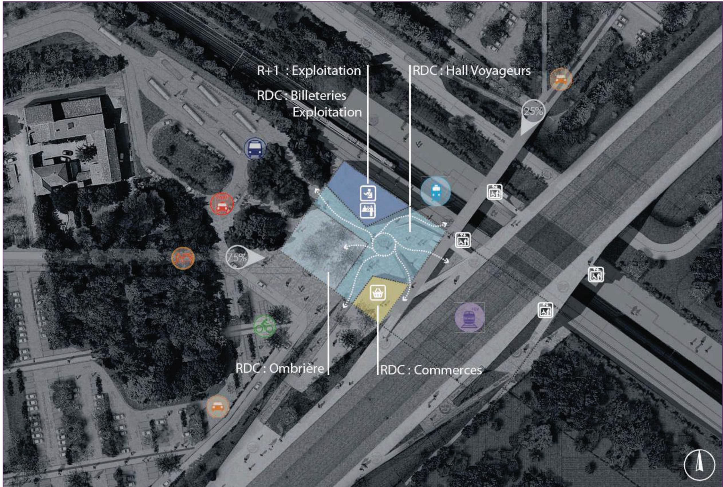
Figure 29 : Plan programmatique de la spatialisation de la gare (source : Etudes préliminaires de la gare nouvelle de Nîmes – Janvier 2015 – Gares et Connexions / AREP)
