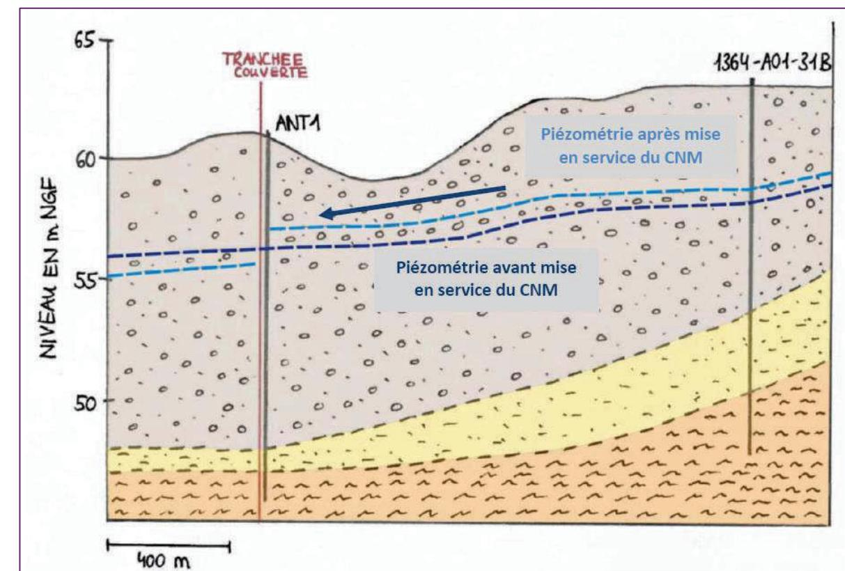
Figure 46 : Coupe géologique schématique (coupe B) au droit du périmètre de réflexion (source : Etude hydrogéologique du Pôle d'Echange Multimodal de Manduel et du Projet Urbain Multimodal de Nîmes Métropole – Antéa Group – Juin 2015)
