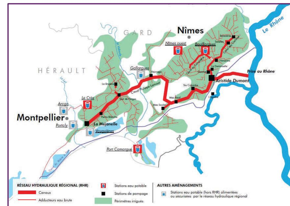
Figure 64 : Schéma des principaux éléments du réseau BRL
