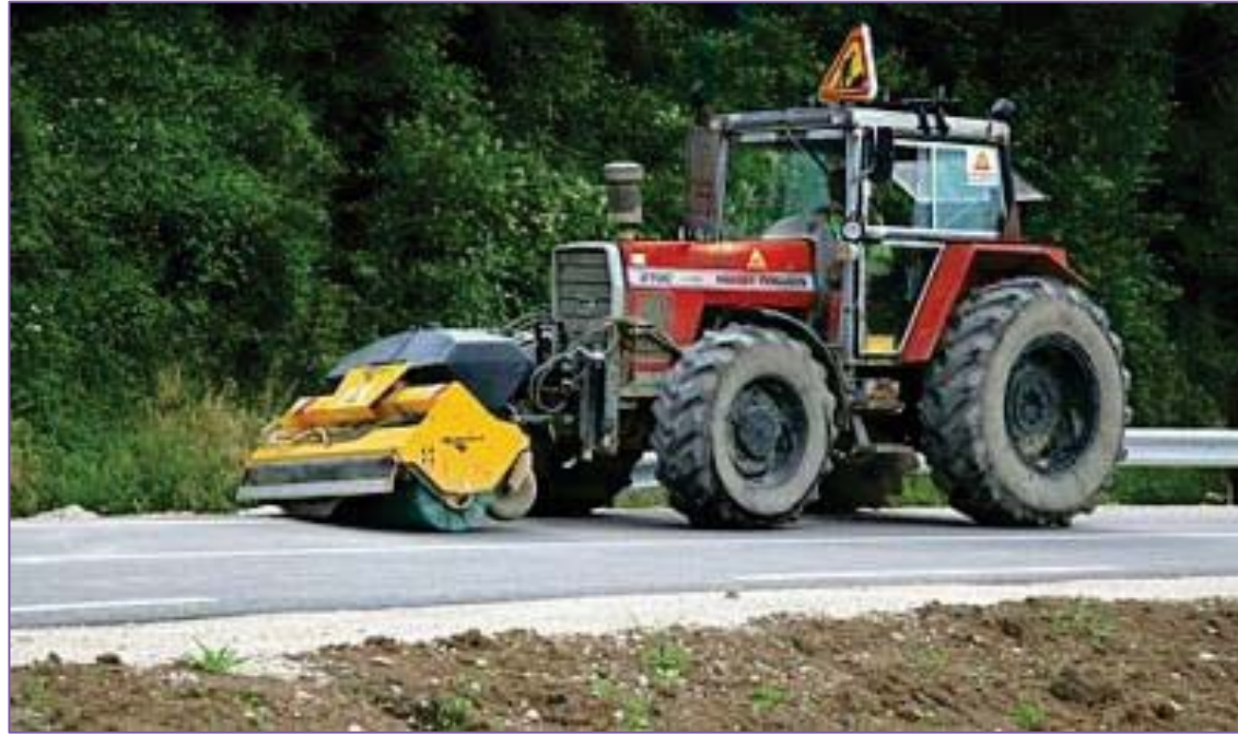
Photographie 55 : Engin nettoyant la chaussée (source : www.lgvrhinrhone.com)
