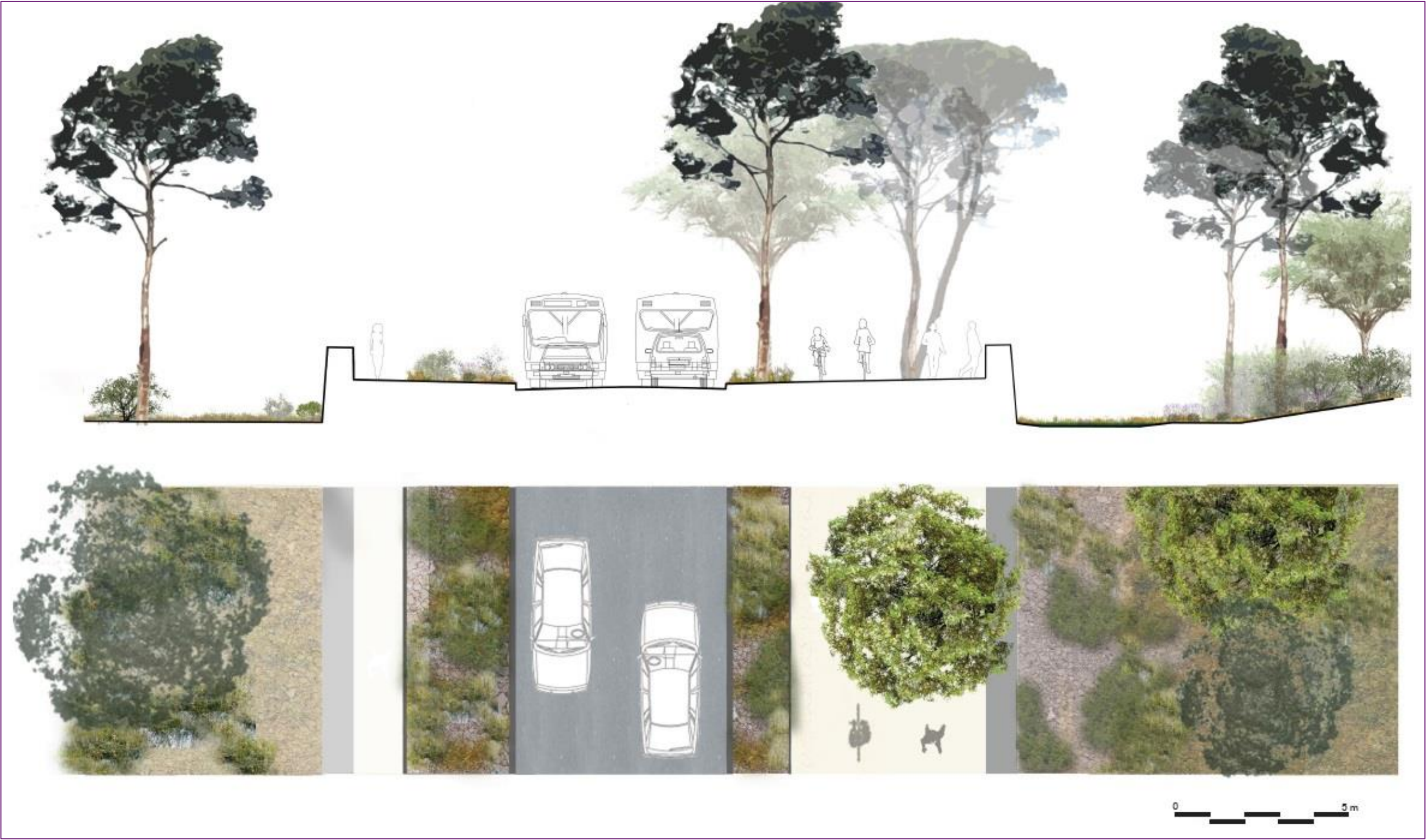
Figure 9 : Coupe de la route digue
