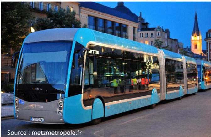
Le BHNS de Metz, Mettis, un véhicule de 24 mètres bi-articulé à motorisation hybride
